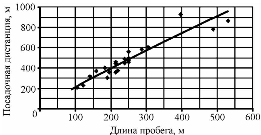
Рис. 2. Статистическая зависимость между длиной пробега и посадочной дистанцией для лёгких самолётов (АП-23).
